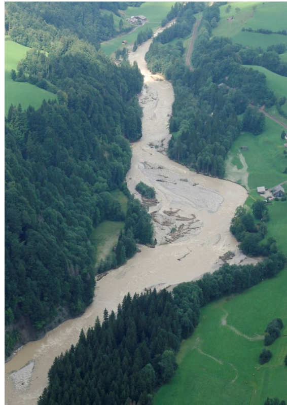
Abbildung 3: Seitenerosion an der Kleinen Emme beim Hochwasser 2005 (Foto: Schweizer Flugwaffe, 2005).
